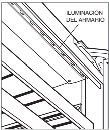
Iluminación del armario.
